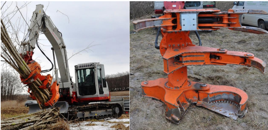
Abbildung 8: Kettenbagger mit Woodcracker C350 (links); geöffneter Woodcracker C350 (rechts)
