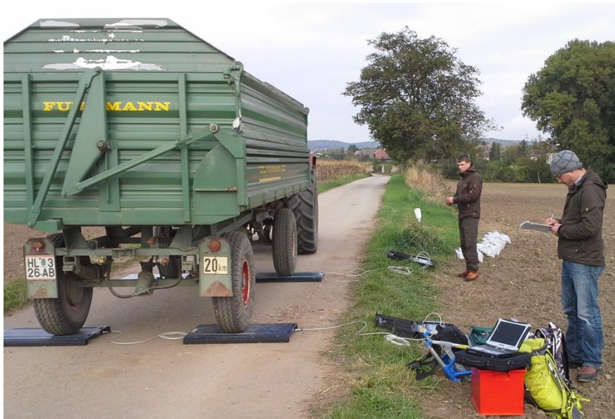
Abbildung 11: Verwiegen der Anhänger mittels mobiler Wiegeplatten
