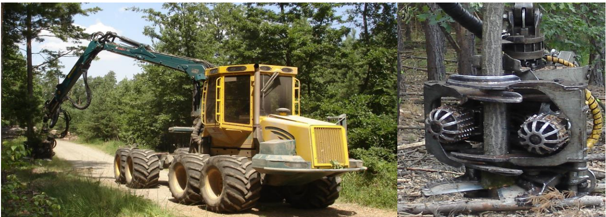
Abbildung 6: HSM 208 f Forwarder (links) mit Moipu 300ES Fäller-Sammler-Aggregat (rechts)
