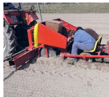
Abbildung 2: Christbaumpflanzgerät beim 2-reihigen Setzen von Weidenstecklingen
