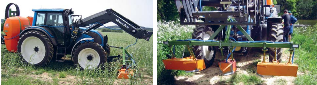
Abbildung 14: Unterblattspritzung (Zwischenreihenspritzung) mit umgebauter Feldspritze
