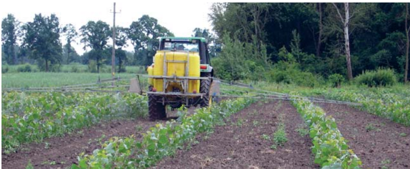
Abbildung 12: Reihenspritzung mit umgebauter Feldspritze
