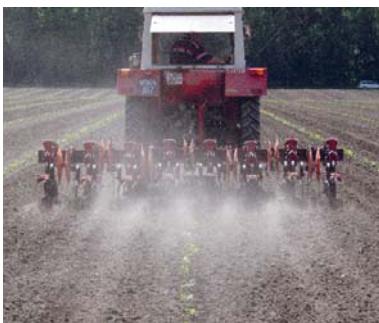
Abbildung 11: Einreihig arbeitendes Rübenhackgerät am Heck angebaut
