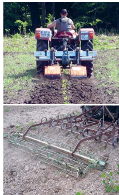
Abbildung 9: Reihenfräse in Kombination mit einer Federzinkenegge
