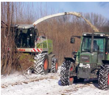
Abbildung 1: Ernte mit dem Feldhäcksler mit einem Spezi- alvorsatz
