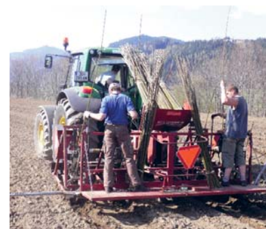
Abbildung 7: 4-reihiges Setzgerät mit Rutenschneidsystem (Step planter)
