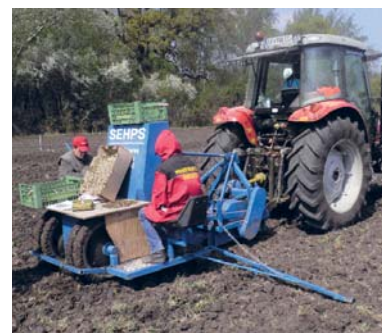
Abbildung 2: Christbaumpflanzgerät beim 2-reihigen Setzen von Weidenstecklingen
