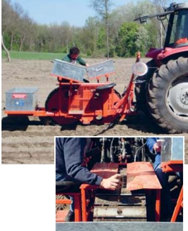
Abbildung 4: 1-reihiges Setzgerät mit Kettenlaufwerk (Eredi Ferri Romolo)
