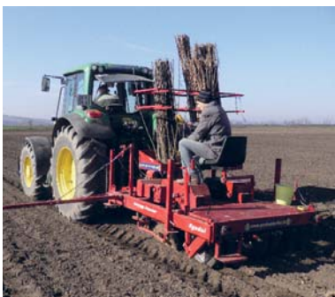
Abbildung 6: 2-reihiges Setzgerät mit Rutenschneidsystem (Egedal)
