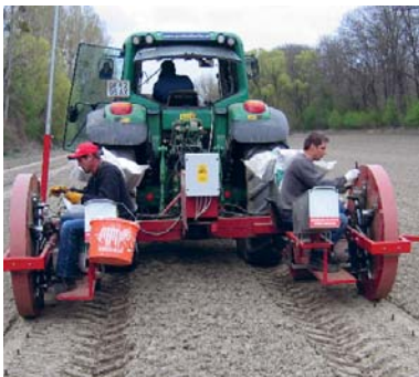
Abbildung 5: 2-reihiges Setzgerät mit Zangensetzelementen (Spapperi)
